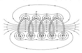
到:內部磁場大小應該與電流大小成正比,另外也應該與線圈密度成正比 (單位長度內的線圈匝數),這是在假設螺管線圈長度遠大於導線直徑的情 形下所得到的,且不討論兩端不均勻的磁場,於是寫下公式:
