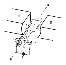
性繼續逆時針旋轉,當 c、d 兩段導線互換位置後,電流卻又與原來方向相同,使線圈繼續以逆時針方向旋轉,於是線圈便一直旋轉下去,將電能轉換為功而輸出。
